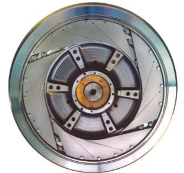
Ruota elastica per tram Combino (Siemens) con sistema Galene. Resilient wheels for Combino Tram (Siemens) with the Galene system.
