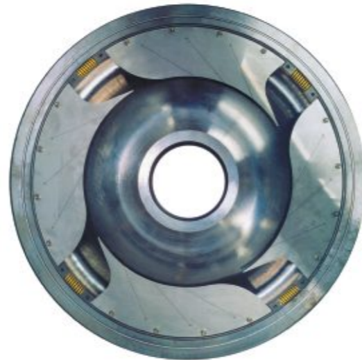
Ruota per carro ferroviario C-Shape con sistema Galene. C-Shape wheel for freight vehicles with the Galene system.
